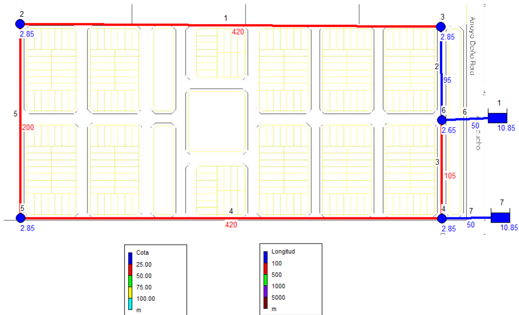
Figura 2: cotas topográficas de los nudos y longitud de los tramos.
