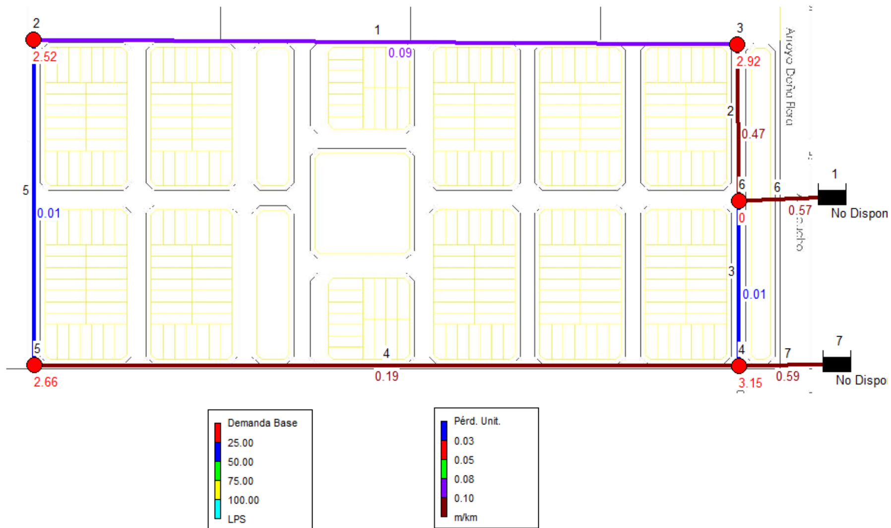
Figura 4: pérdida unitaria de carga en las cañerías y demanda base en cada uno de los nudos.
