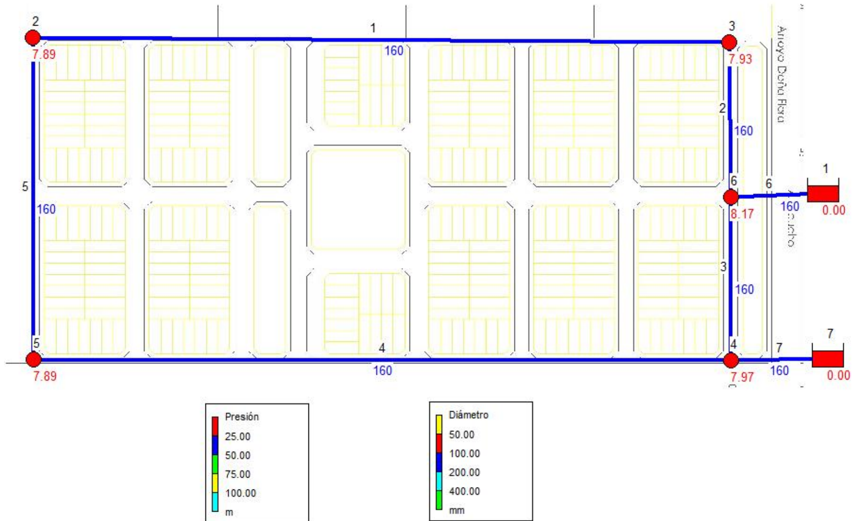
Figura 3: diámetros de las cañerías y presión en cada uno de los nudos.
